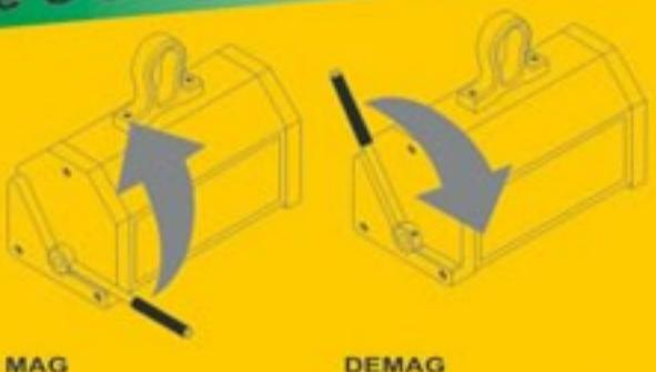
Prin simpla rotire a manetei, MaxX este activat sau dezactivat. Un dispozitiv de auto-blocare previne orice posibilă dezactivare accidentală a manetei atunci când se află în poziția MAG.
