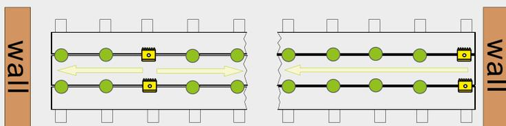
A / Clip di espansione contro il muro, min. 2,5 mm di distanza per ogni metro di doga.
