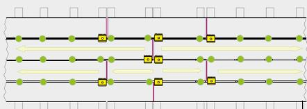
Le doghe centrali vanno fissate con la clip di bloccaggio al centro. Le due doghe esterne vanno fissate con la clip di bloccaggio laddove incontrano le doghe centrali in modo che la loro dilatazione sia forzata verso l'esterno. Lasciare uno spazio di 2 mm per ogni metro di dogha dove sono presenti pareti.
