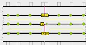
Fissare con la clip di bloccaggio lungo la linea centrale dove si incontrano le estremità delle doghe
