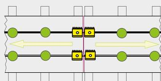
Fissare con la clip di bloccaggio nel punto in cui le due estremità delle doghe si incontrano.
