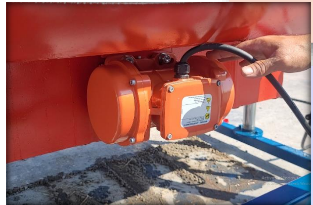
Vibrator profesional frecvență 3000rpm
