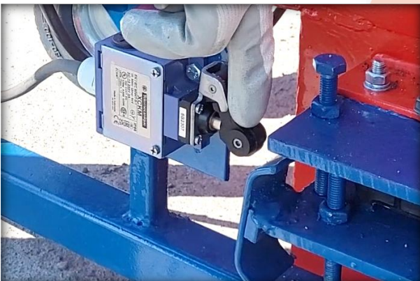
Oprirea automată a vibrației la decofrare
