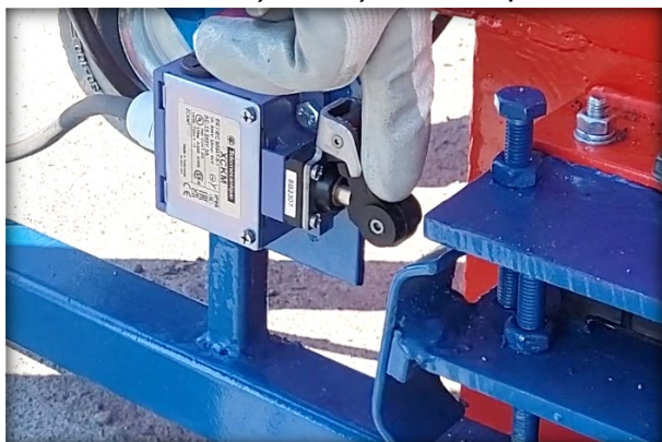
Oprirea automată a vibrației la decofrare, decofrare comandată automat la atingerea cotei de înălțime stabilită pentru piesa din beton fabricată
