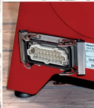
Presca interbloccata multipolare per collegamento rapido e sicuro del quadro elettrico.
