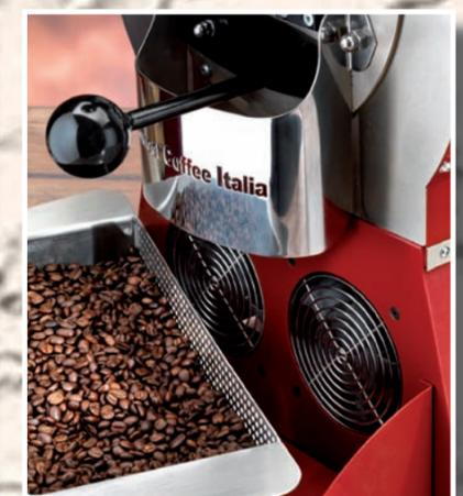
Vasca di raccolta del caffè tostato in acciaio inox AISI con sistema di raffreddamento, fascia di protezione ingresso camera di tostatura in acciaio inox AISI, e sportello con indicatore visivo di tostatura e contrappeso di chiusura .
